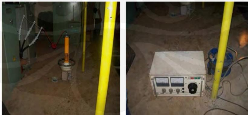
Gambar 4.1 Pengujian Isolasi Kabel TM
