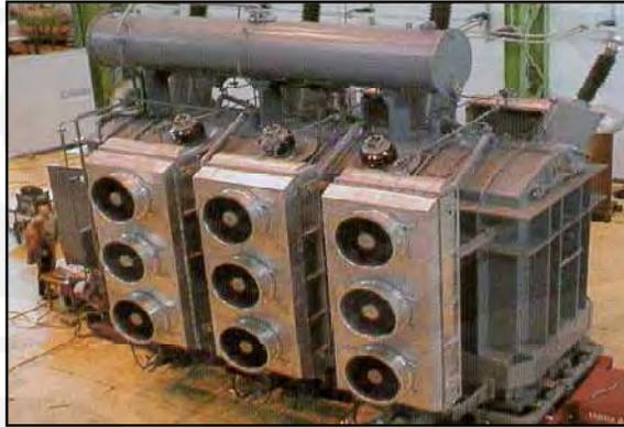
Gambar 2.11. Susunan Motor Blower untuk Alat Pendingin Minyak Transformator secara udara dipaksakan
