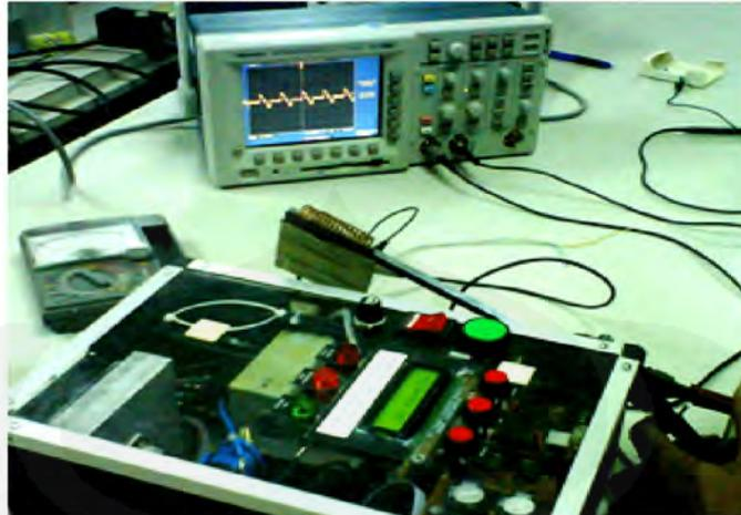
Gambar 4.14. Bentuk gelombang arus pada tangki resonansi paralel
