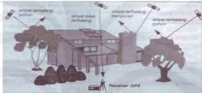
Gambar 2.3. Penjalaran sinyal GPS yang terhalang dan tidak terhalang [1]
