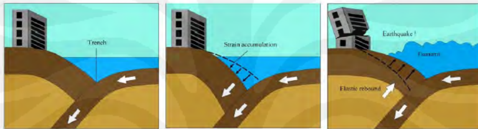
Gambar 2.3 Pergerakan lempeng pada daerah patahan yang akan menimbulkan deformasi dasar laut secara vertikal yang akan menyebabkan timbulnya gelombang tsunami [Mori 2004].
