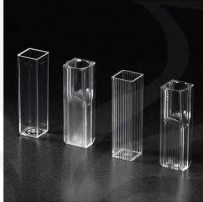
**Gambar 2.15.** Sel tempat *sample* (*cuvette*/kuvet)
