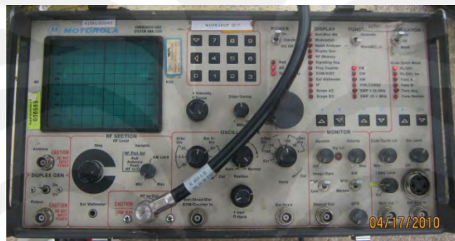
Gambar 3.14 Setup pengukuran Frekwensi Error
