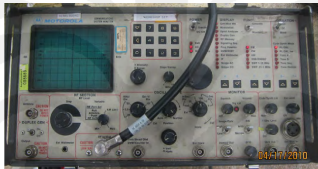
Gambar 3.17 setup pengukuran sensitifitas penerima
