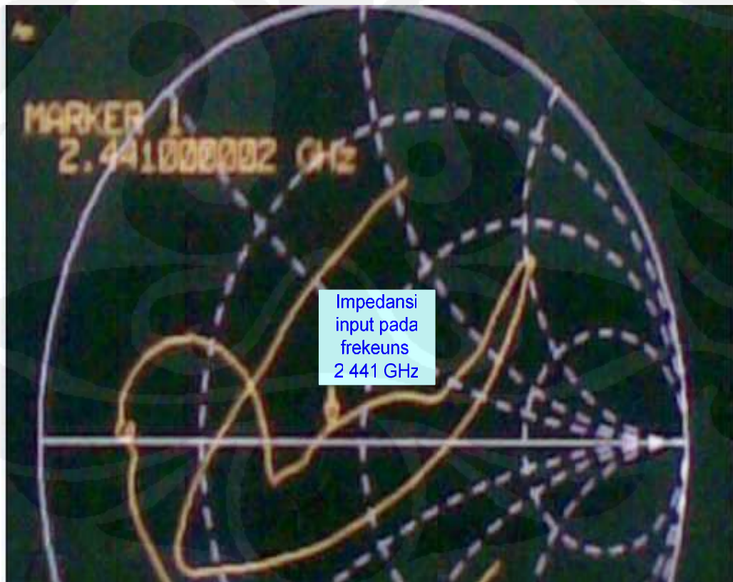
Gambar 4.15 Hasil pengukuran impedansi input antenna omnidirectional
