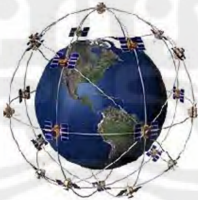
Gambar 2.1 Konsep Konstelasi Satelit GPS [1]
