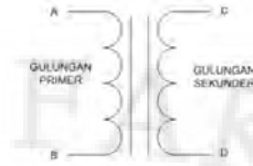
Gambar 3.6 Trafo secara umum
