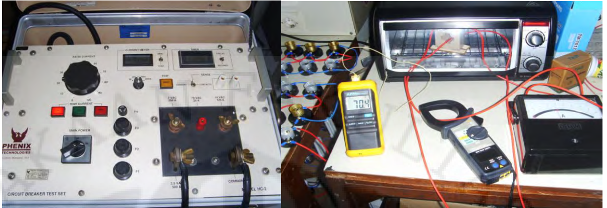
Gambar.3.5 : Pengujian CT dengan Temperatur
