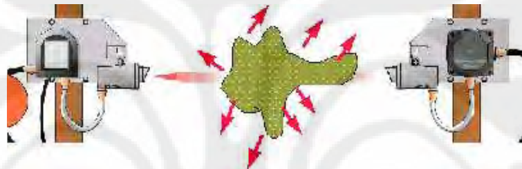
Gambar 2.11 Kondisi Terdeteksi Gas dari IR Open Path Gas Detektor
