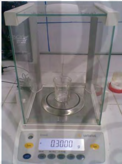
Gambar 3.2 Penimbangan bahan nonlogam menggunakan Sartorius Extend
