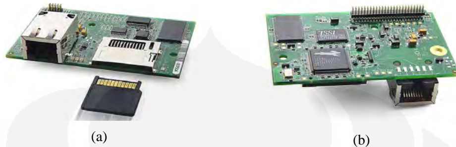
Gambar 4.1. Fisik Modul Rabbit RCM4300. [7] (a) tampak atas (b) tampak bawah
