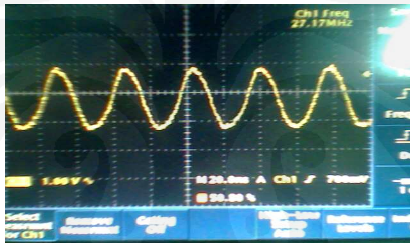
Gambar 4.7 Sinyal Masukan Rangkaian Radio Konverter channel 2
