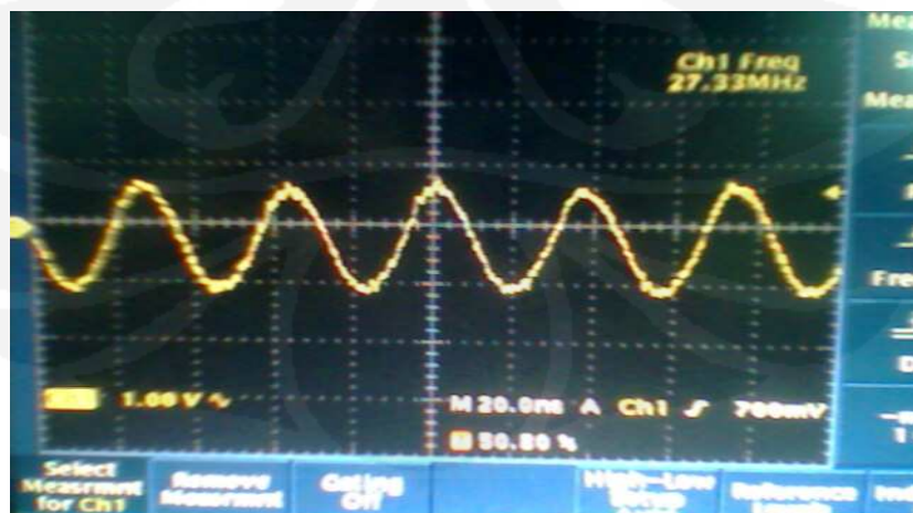
Gambar 4.8 Sinyal Masukan Rangkaian Radio Konverter channel 3
