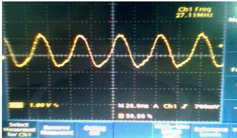
Gambar 4.6 Sinyal Masukan Rangkaian Radio Konverter channel 1
