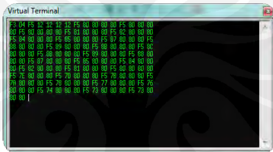
Gambar 4.6 Data serial yang dibaca virtual terminal di isis
