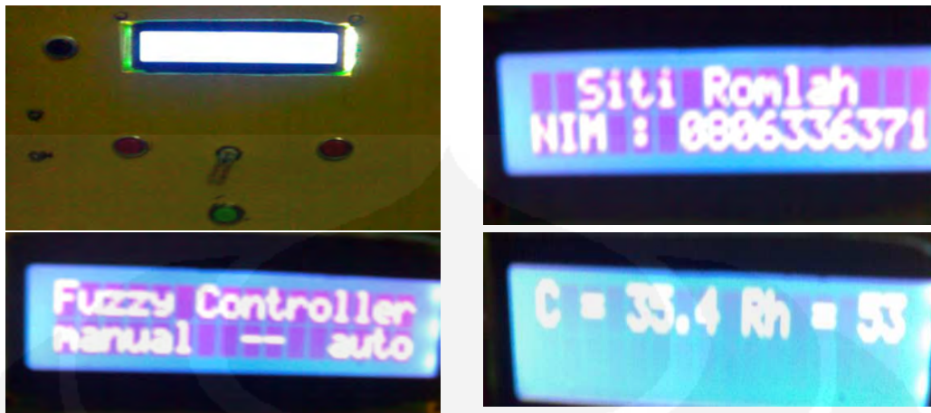
Gambar 3.12 Hasil Rancangan Output Mikrokontroler dengan Tampilan LCD
