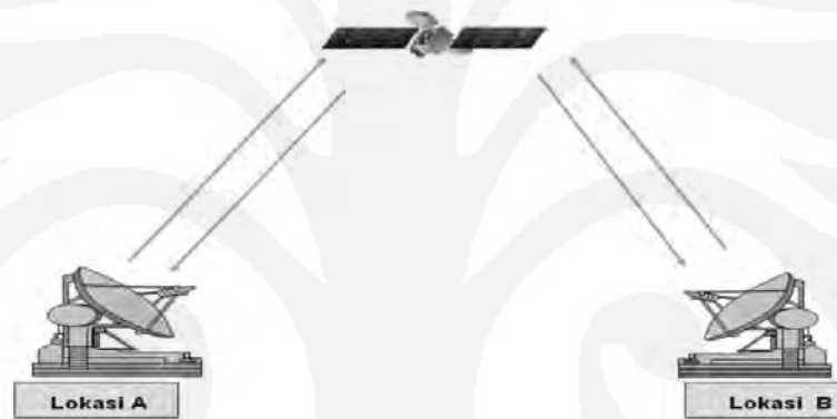
Gambar 3.1 Konfigurasi Link Point to Point
