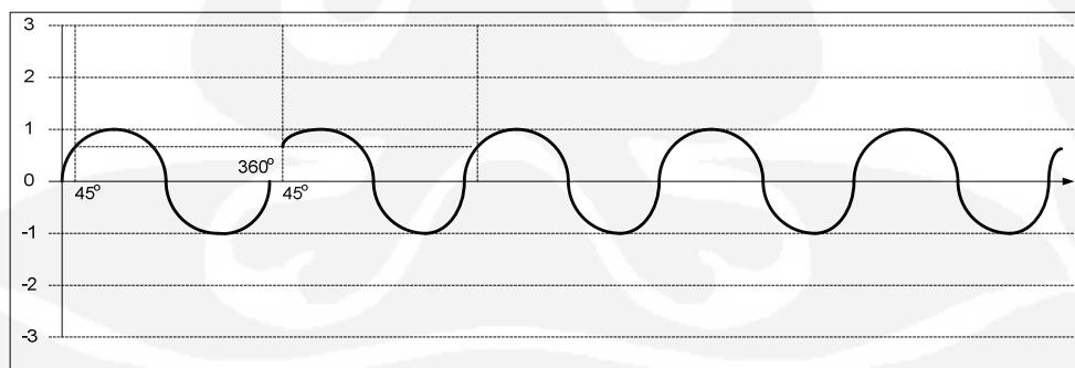
Bit 0011 dengan amplitudo 1 dan beda fasa 45^\circ
