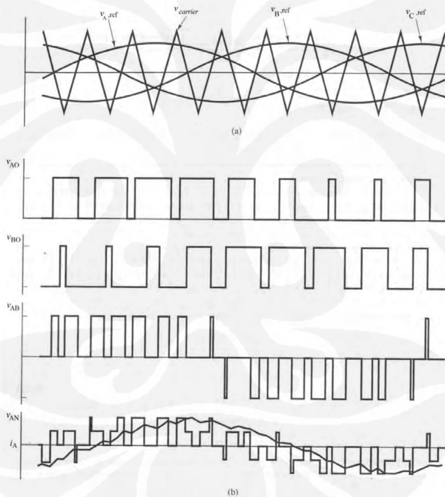
Gambar 2.6 : (a) gelombang carrier dan gelombang referensi untuk operasi PWM. (b) bentuk output-arus untuk beban R-L. [1]
