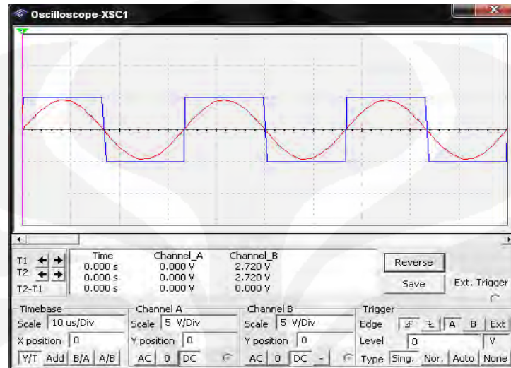
Gambar 3.2a Sinyal oscilloscope keluaran dari operational amplifier LT 1807CMS8
