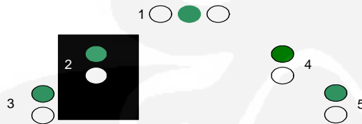
Gambar 4.5 Sensor kiri 1 mendeteksi jalur.
