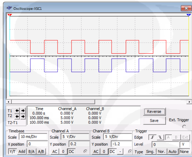
Gambar 3.3 Keluaran pada pin IC 74LS04
