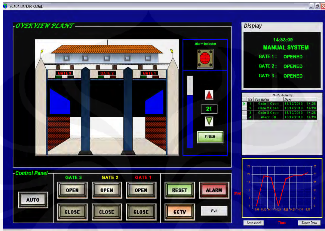
Gambar 4.2 Alarm Hidup Dengan Menaikan Ketinggian Air Secara Manual
