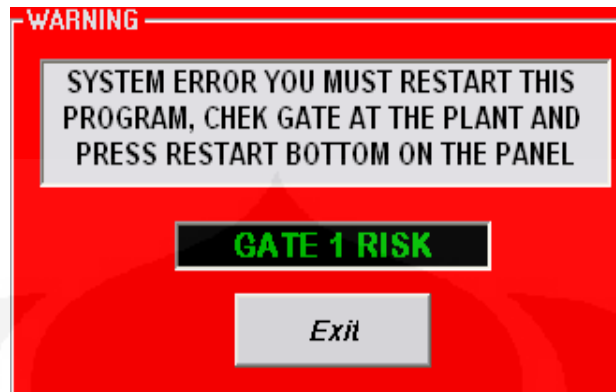
Gambar 4.4 Tampilan Tanda Peringatan Jika Kerusakan Pada Salah Satu Pintu
