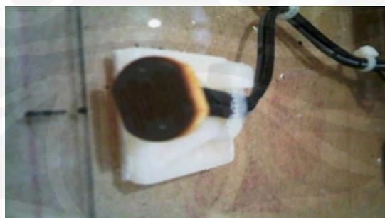
Gambar 3.4 Konfigurasi posisi LDR dalam miniatur perempatan jalan
