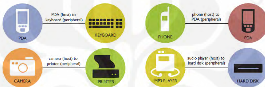
Gambar 2.8 Skema Koneksi USB OTG [6]
