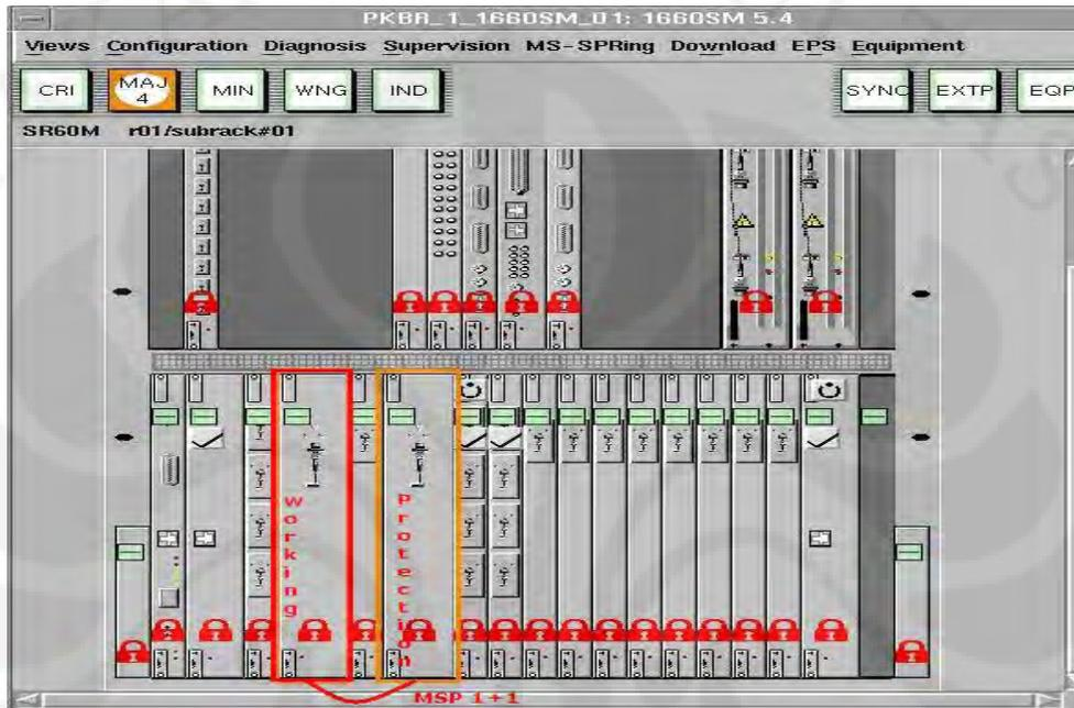
**Gambar 4.1** Konfigurasi perangkat mux dan link proteksi 1+1
