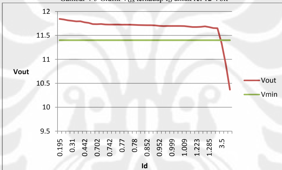
Gambar 4-6 Grafik V_{out} terhadap I_D untuk rel 12 Volt
