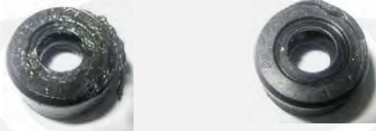
Gambar 1.2. Seal rusak akibat kesalahan pemasangan secara manual
