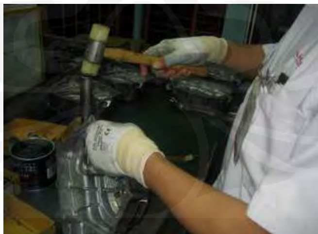
Gambar 1.1. Pemasangan seal secara manual
