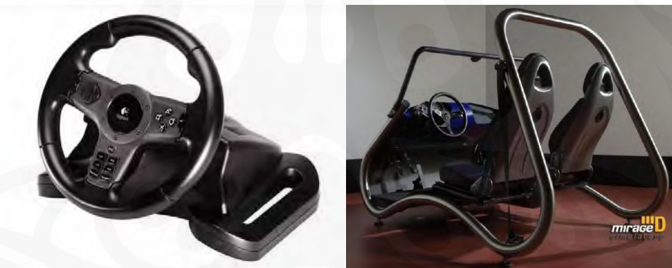
Gambar 4. 20: Steering Wheel Controller (kiri) dan Steering Wheel Controlle dengan penambahan layar lebar (kanan)
