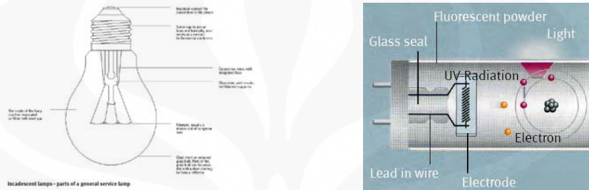
Gambar 3.19 Lampu Pijar (Kiri) dan Lampu Discharge (Kanan). Sumber: Materi Kuliah Pencahayaan semester gasal 2006/2007.
