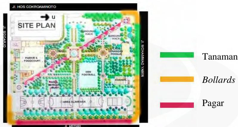
Gambar 4. 57 Letak Penghalang pada Site Plan
