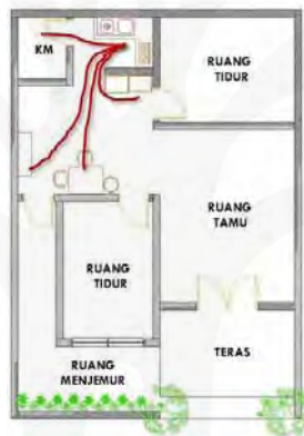
Gambar 3.50 Area Kerja Tambahan Di Luar Dapur
