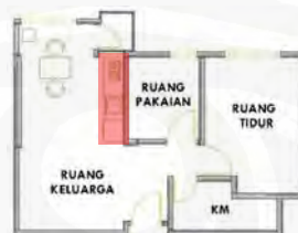
Gambar 3.64 Denah dan Tata Letak Dapurnya dalam Rumah Tinggal Keluarga Muda (b) Saat Ini
