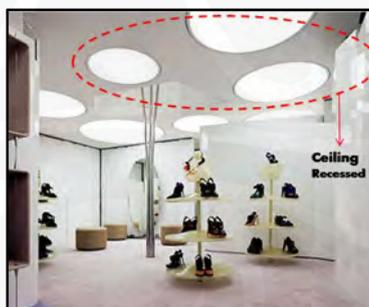
**Gambar 2.11** Pemasangan Lampu yang Tertanam pada Langit-Langit.
