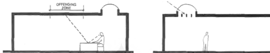
Gambar 2.12 (a) Penempatan skylight diluar offending zone dan (b) sistem penghalang untuk menghindari silau
