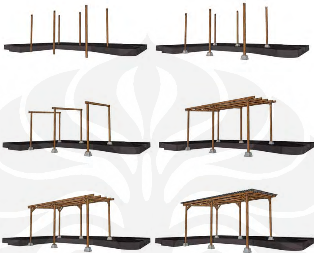
Gambar 3.34 Proses pembangunan bangunan parkir
