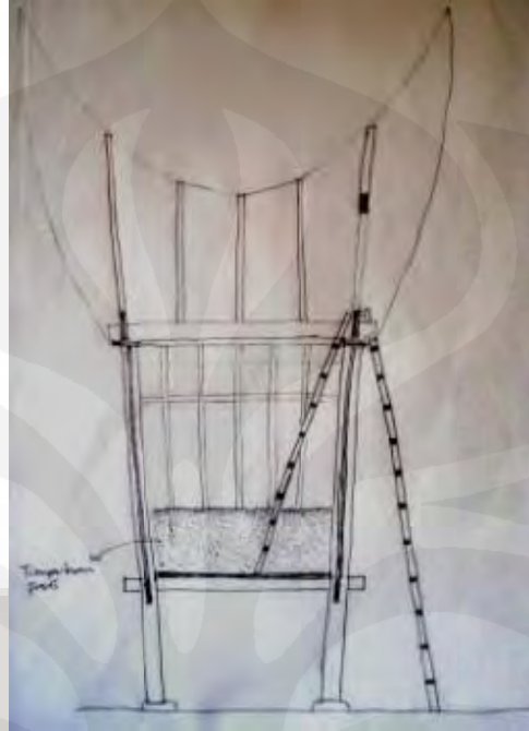
Gambar 5.47 Potongan yang menunjukkan ruang dalam dan jangjang pada rangkiang
