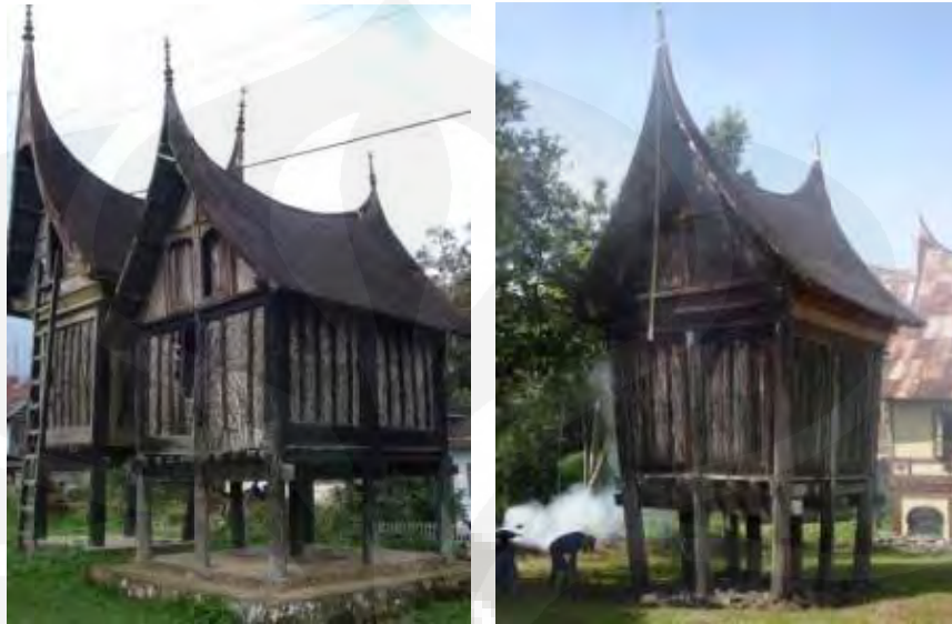
Gambar 5.45 Contoh rangkiang dengan jumlah tonggak 4 dan 9
