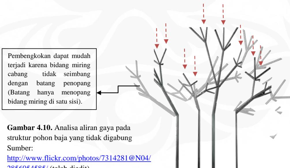
**Gambar 4.10.** Analisa aliran gaya pada struktur pohon baja yang tidak digabung
