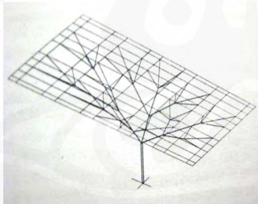
**Gambar 4.5.** Satu struktur pohon baja menopang satu atap tunggal
