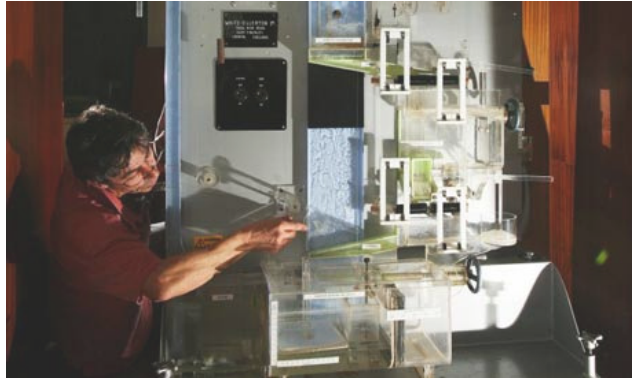
Gambar 4.2. Mesin Moniac buatan Bill Phillips
