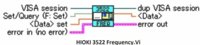
Gambar 3.13. Ilustrasi pengaturan frekuensi oleh driver HIOKI.
