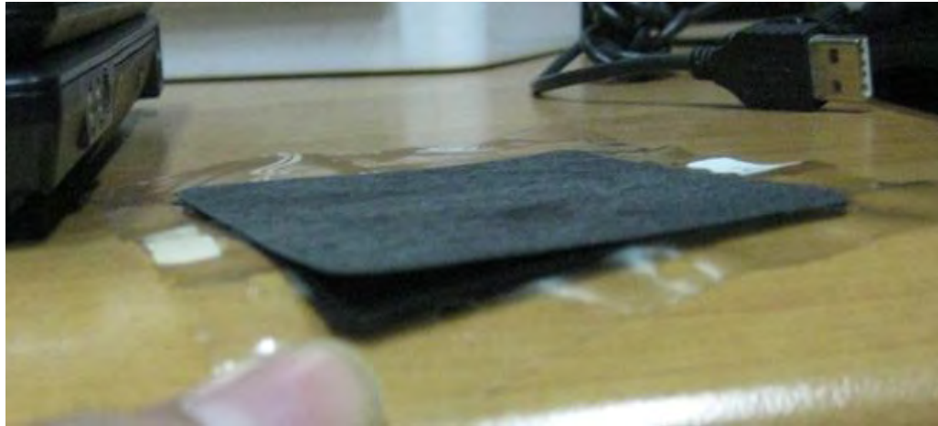
Gambar 4.12. Kondisi MEA dengan PTFE setelah pengujian 16 jam
