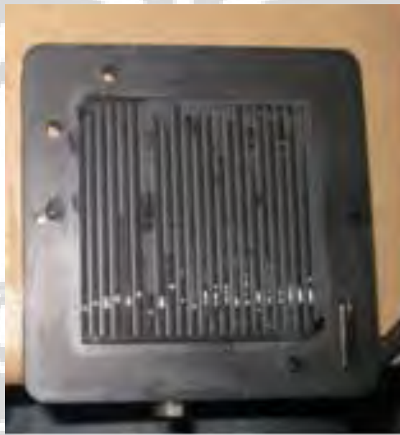
Gambar 4.11. Kondisi Plat Grafit bagian dalam pengujian MEA dengan PTFE
