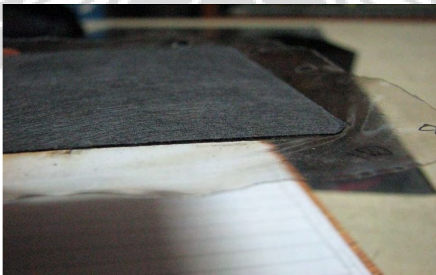
Gambar 4.17. Kondisi MEA dengan FEP setelah pengujian 40 jam
