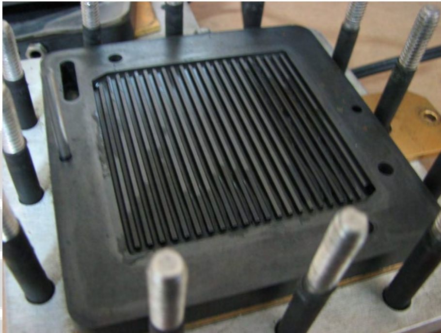
Gambar 4.16. Kondisi Plat Grafit bagian dalam pengujian MEA dengan FEP
