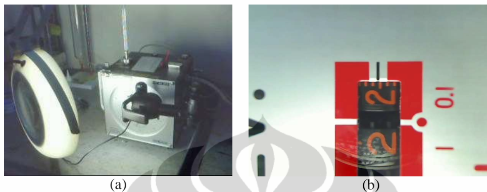
Gambar 3.19 : Dial register (a) penempatan kamera USB dan meter dengan tampilan dial register (b) citra karakter yang diperoleh kamera
