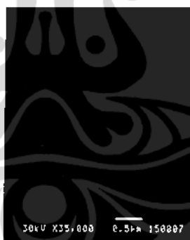
Gambar 4.18 Foto SEM lapisan tipis BST dengan perbesaran 35000x
