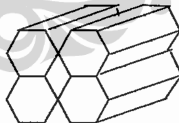
Gambar 2.5. Skematis host interkalasi dari grafit
