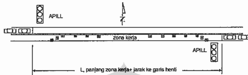
Gambar 2.4. Instalasi APILL Pada Zona Kerja
