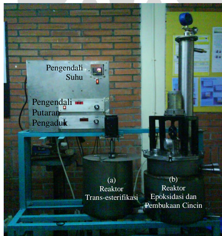
Gambar 3.3. Reaktor untuk preparasi minyak dasar
