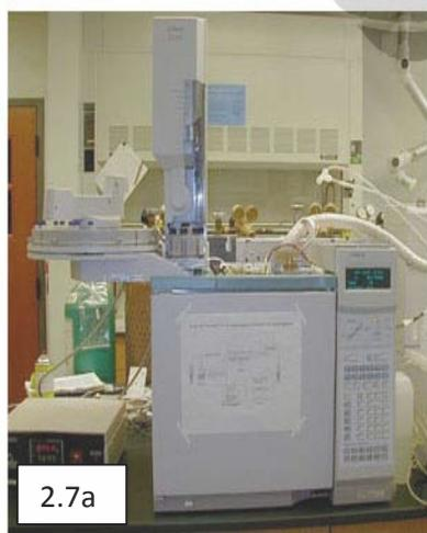
Gambar:2.7.a. Alat kromatografi gas
