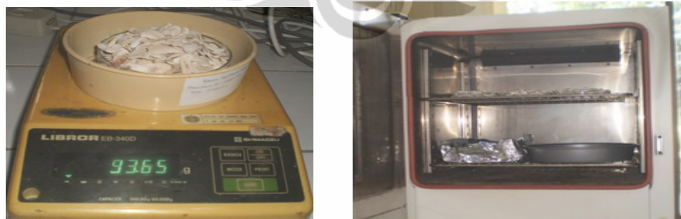
Gambar 4.2 Sebelah kiri penimbangan biji mahoni sebelum dioven, dan sebelah kanan proses pengeringan dengan oven
