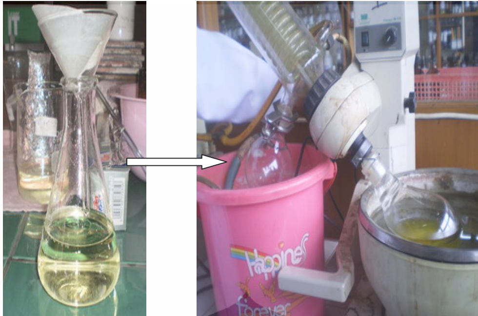
Gambar 4.9 Penyaringan minyak setelah pemucatan (sebelah kiri), dan evaporasi filtrat hasil penyaringan (sebelah kanan)
