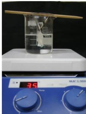
Gambar 11. Alat uji disolusi termodifikasi
