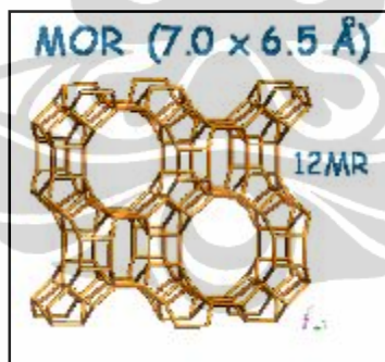
Gambar 2.6 Struktur rangka mordenit (Schmidt, W., n.d)
