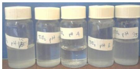
**Gambar 4.19. Foto Dispersi TiO<sub>2</sub> dalam Air dengan Variasi pH Setelah 1 Hari**
