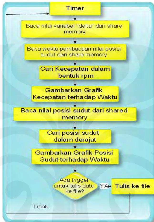
Gambar 3.15 Diagram Alir Algoritma Penghitung Kecepatan Putar pada Program VSGP
